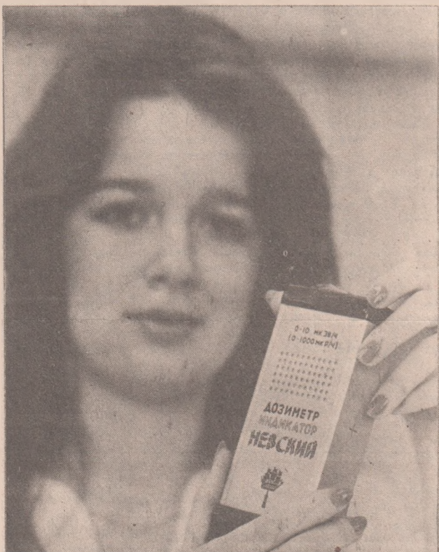
ЛЕНИНГРАД. В центральном научно-производственном объединении «Ленинец» изготовлена опытная партия бытовых дозиметров, осуществляющих замер радиоактивного излучения от 0 до 1000 микрорентген в час. Их серийное производство начнется в этом году. На снимке: новый бытовой дозиметр.
